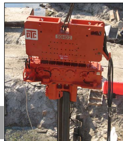
В работе со шпунтовыми сваями применяется зажимной наголовник Agriplex 170 т.
